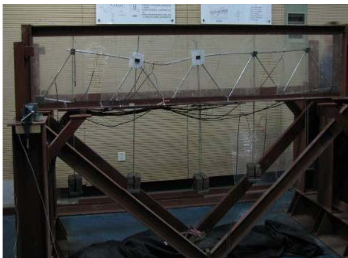
单榀桁梁的最终状态
