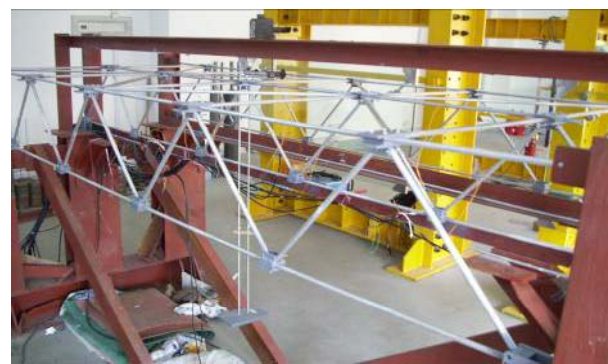
多榀桁梁结构三维系统模型
