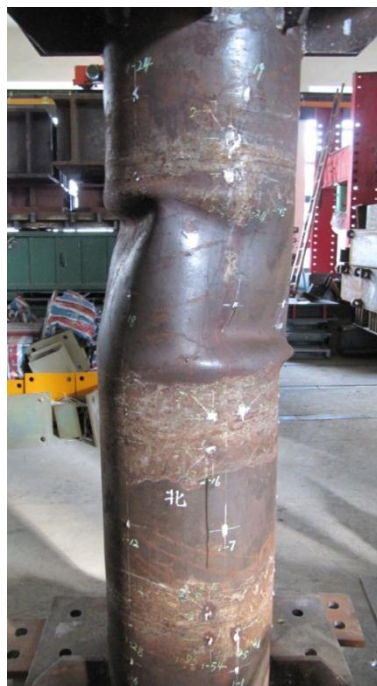
图 7 柱 T-90 管壁屈曲变形情况
